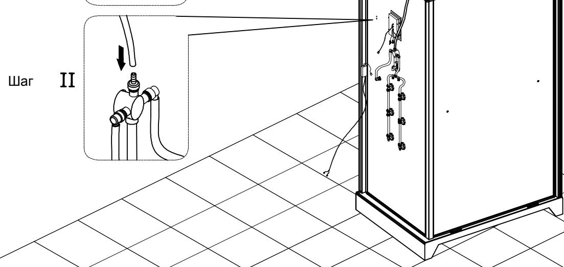
**(27) Схема подключения оборудования**
