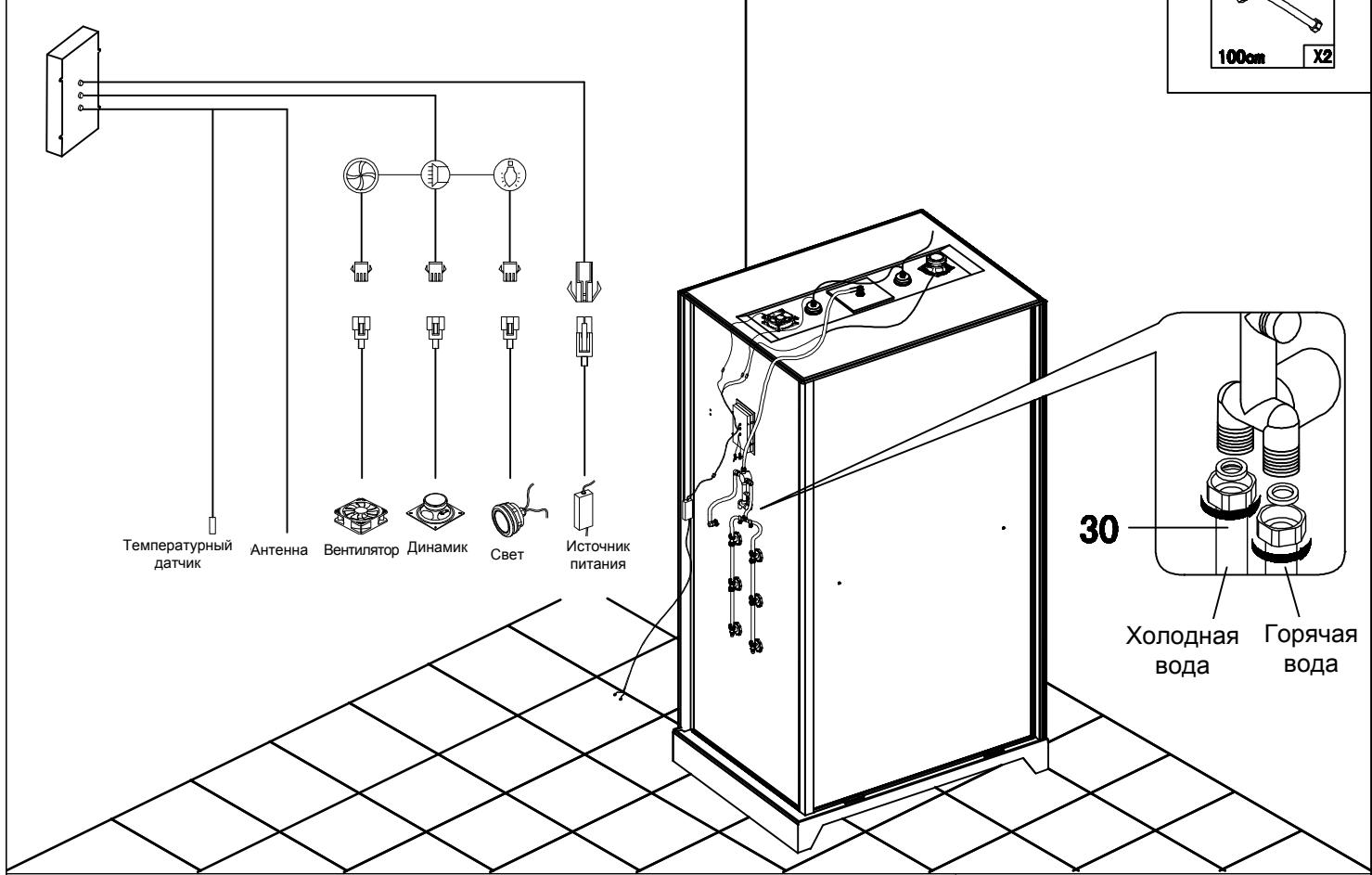
**(28) Подключение антенны и датчика температуры**
