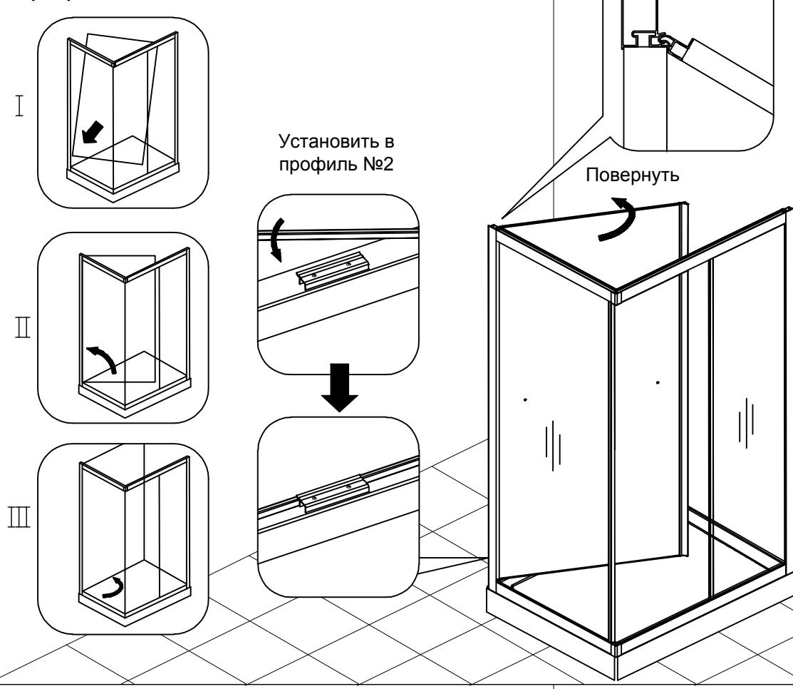
(14) Установка стенки с панелью управления
